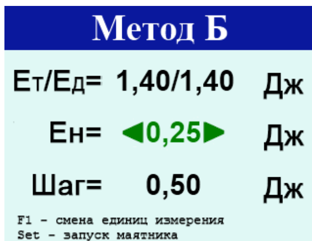
Рисунок 4 - Меню «Метод Б». Работа при задании энергии (пример)
