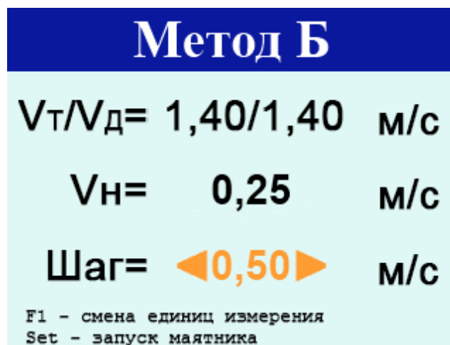
Рисунок 5 - Меню «Метод Б». Работа при задании скорости (пример)
